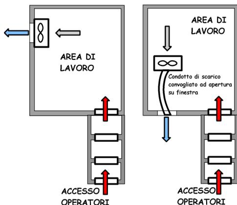
Figura 44 - Confinamento dinamico con estrattori d'aria
