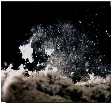
Figura 12 - Friabilità e rilascio fibre
