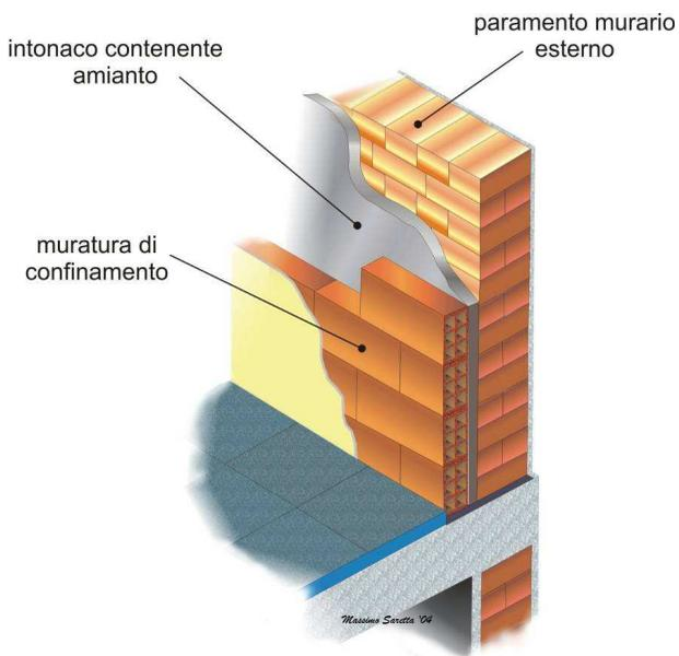
**Figura 18 - Confinamento intonaco contaminato**
