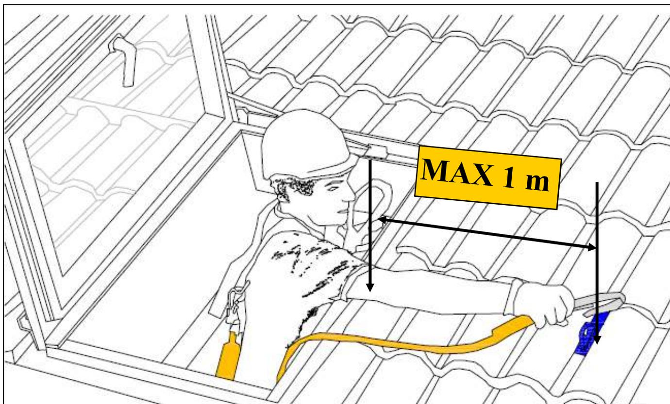
*La posizione del dispositivo di ancoraggio deve essere tale da permettere all'operatore un facile e sicuro collegamento prima di uscire sulla copertura.*
