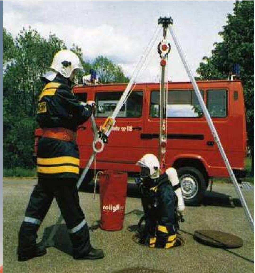
Il recupero di un operatore da parte di un altro operatore può pretendere il taglio della fune di sostegno del caduto
