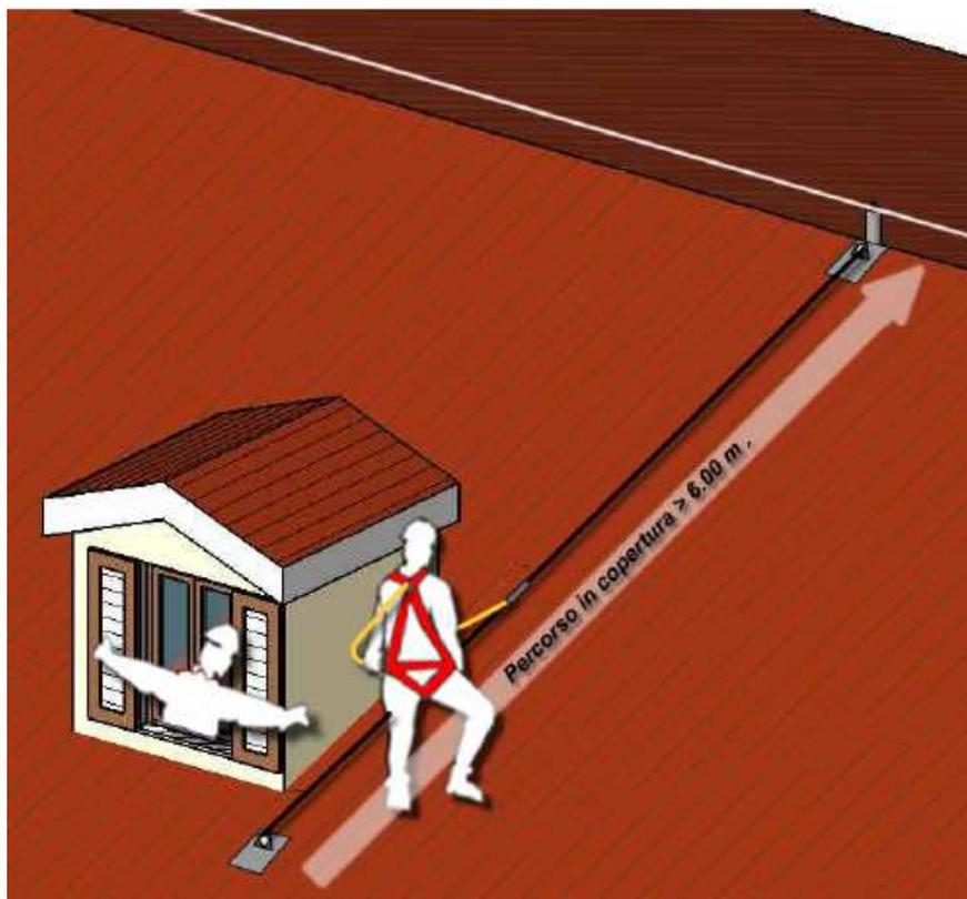
In caso di copertura con inclinazione inferiore a  $15^\circ$  è possibile utilizzare un cavo di risalita. Per inclinazioni superiori ( $15^\circ - 30^\circ$  max), si può utilizzare in luogo dei ganci un sistema anticaduta UNI EN 353-1 completo di navetta. Ancorarlo ad un palo della linea vita.
