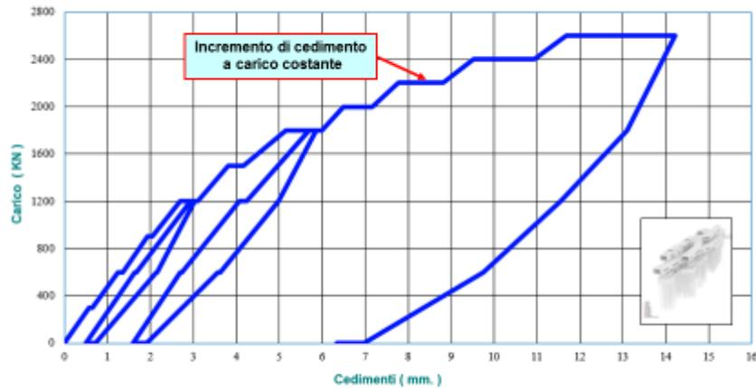
Controllo delle deformazioni viscosi del terreno
