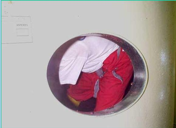
Cantine: un addetto alla estrazione delle vinacce che è entrato all'interno del tino per completare l'operazione.
