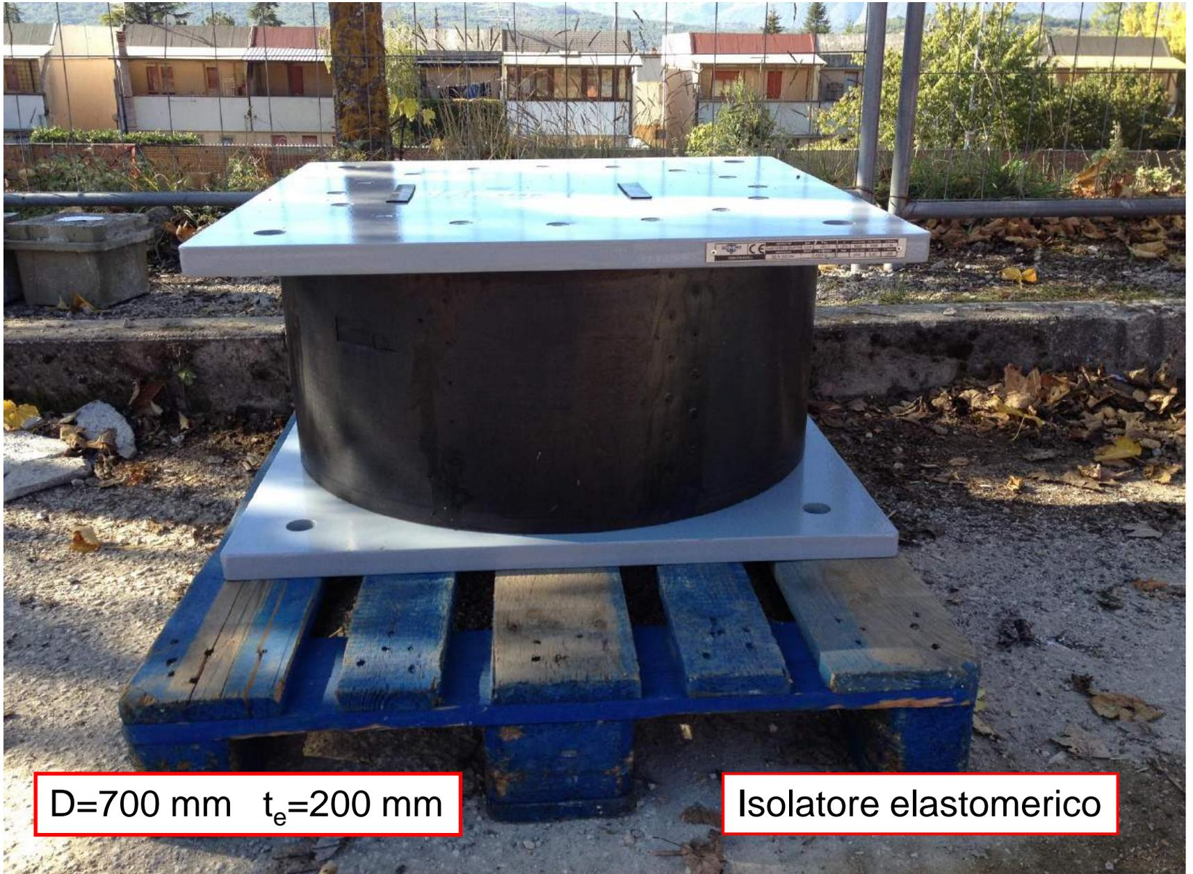
$D=700 \text{ mm}$     $t_e=200 \text{ mm}$
