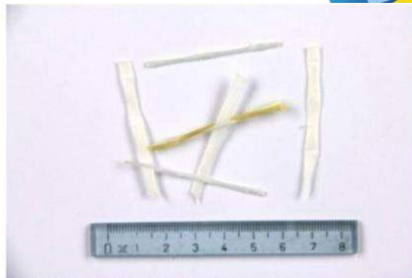
Struttura del campione dopo 24 ore in NaOH (20%) a 50°C
