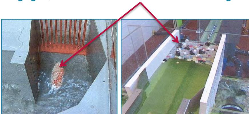
Pre-rotazioni, vortici ecc., possono essere verificati solo attraverso modelli. Una pompa può anche essere modificata, sostituita o adattata, mentre una volta realizzata la vasca pompe, difficilmente si possono effettuare radicali modifiche in caso di presenza di anomalie ai flussi
