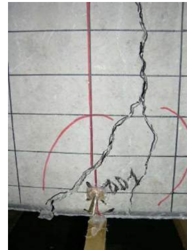
RC-C: FRATTURA AMPIA CON ESPULSIONE DI CLS
