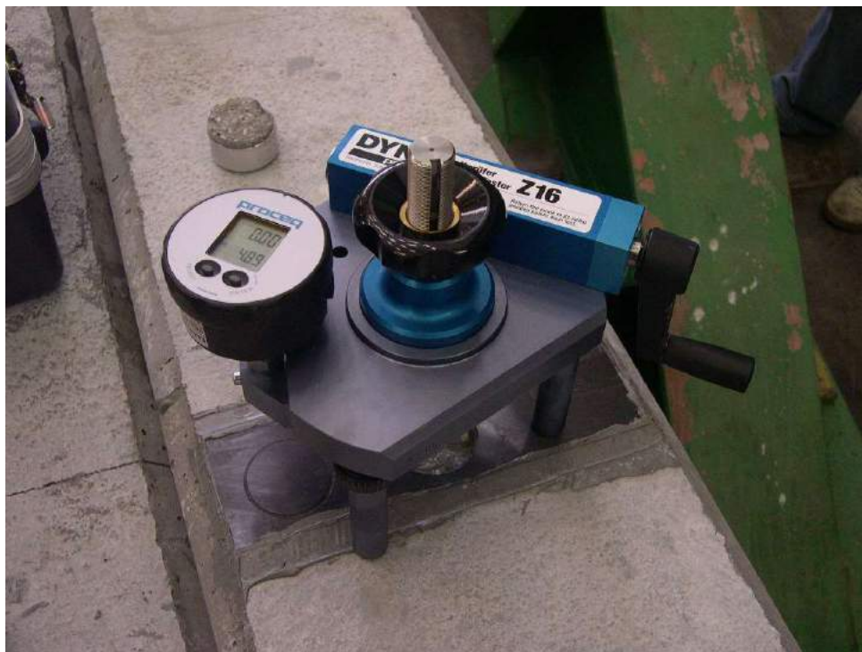
Apparecchiatura per prova pull-off
